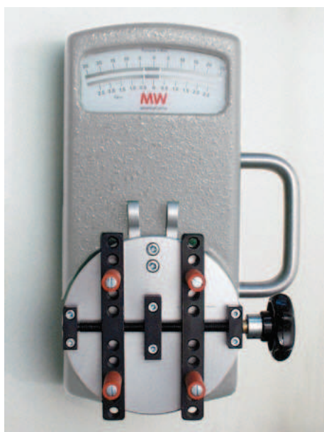
Torque-Tester zur Überprüfung der Öffnungswerte
